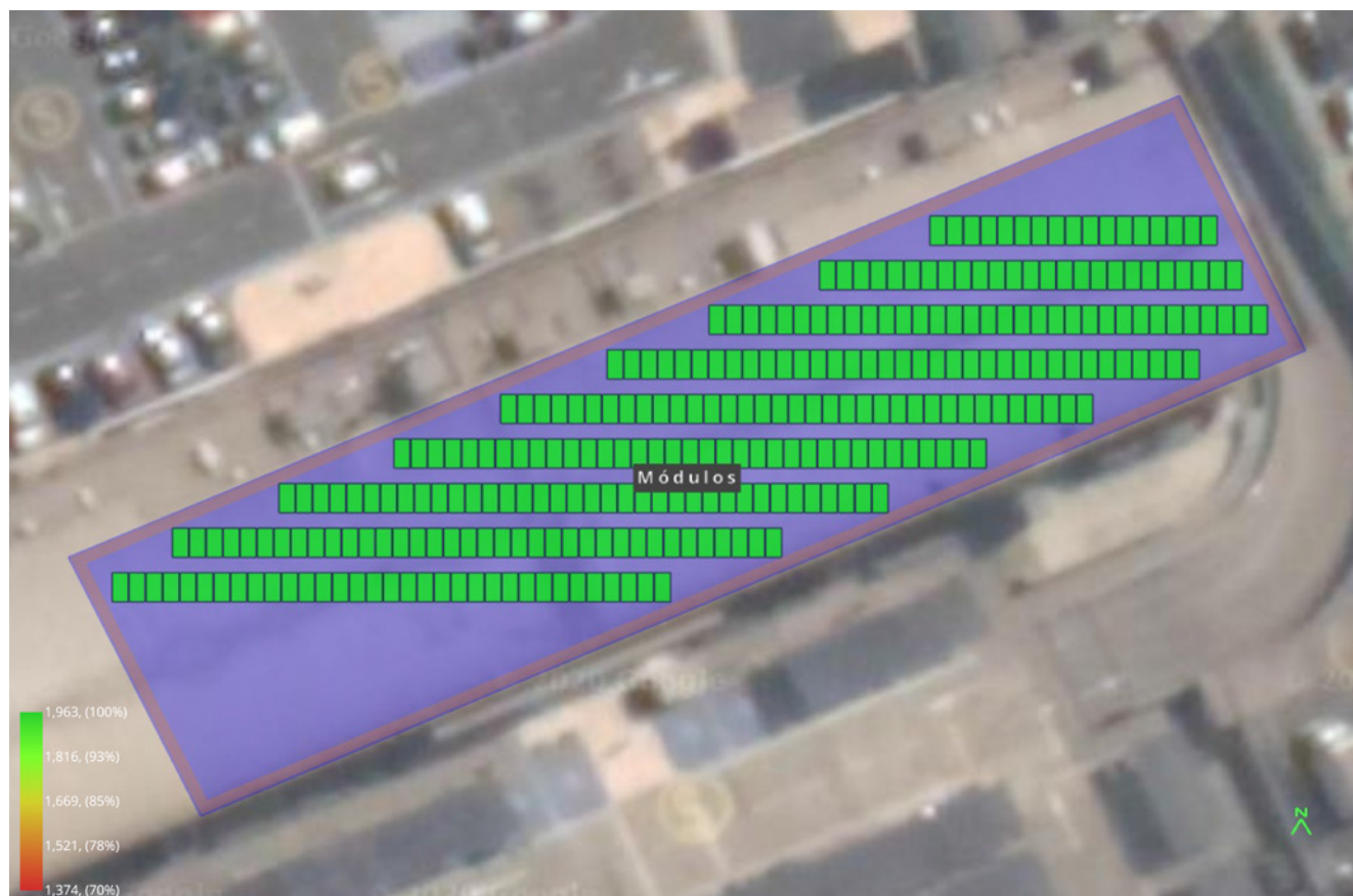
Figura 5. Distribución de módulos fotovoltaicos con Helioscope
