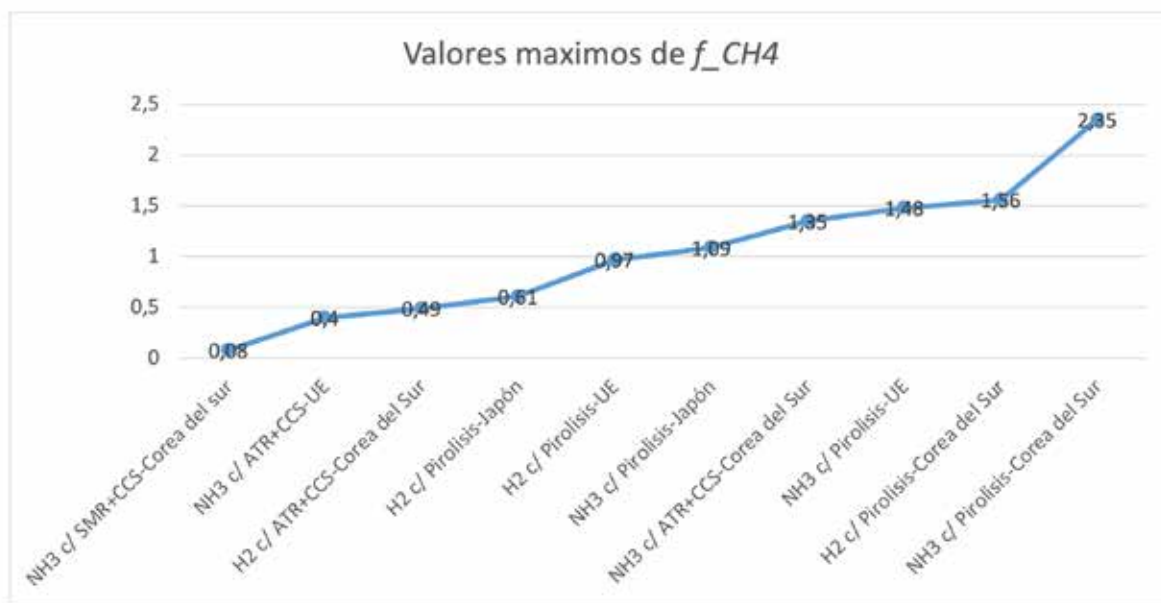
Figura 5. Valores máximos de f_{CH4} en Argentina en función del proceso considerado de síntesis del amoniaco con gas natural.
